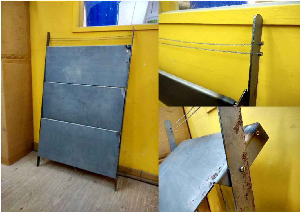
圖 3-10 置物架第一版原型：高度過矮且全鐵材重量頗重、上方鋼纜無法拉緊強化結構、旋轉支點錯誤無法順利拉起層板
