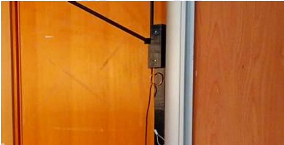
圖 3- 29 大型燈具製作過程：為提高摩擦力而附加的 S 型紅銅管。
