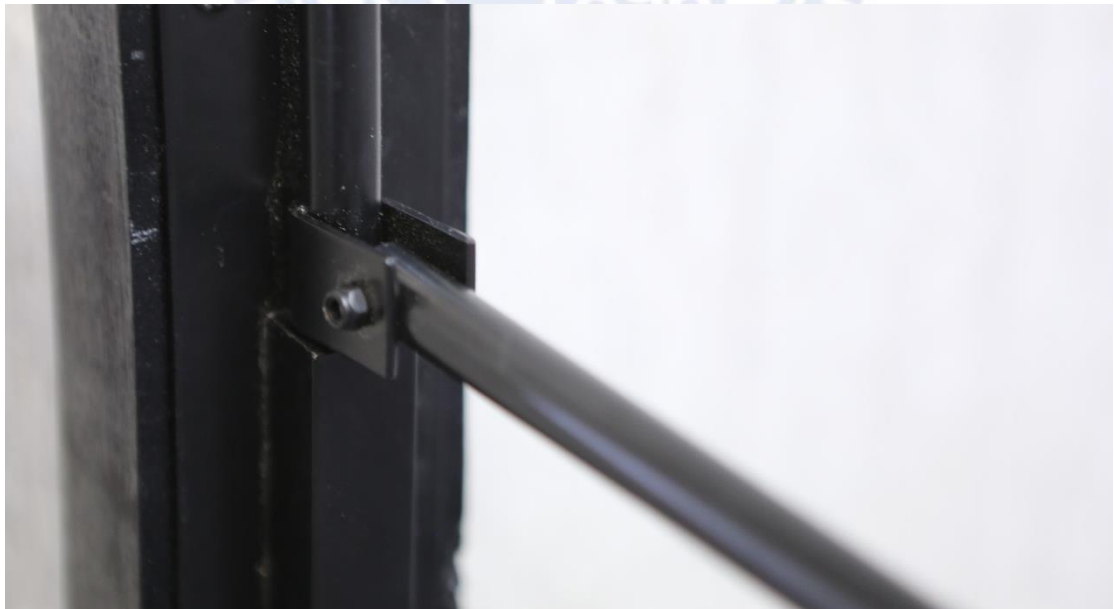
圖 3- 27 大型燈具第一版原型製作過程：支架與鎖牆鐵片的間隙過短，因支架內部與鎖牆鐵件有電線穿過，使得支架不容易上下旋轉。
