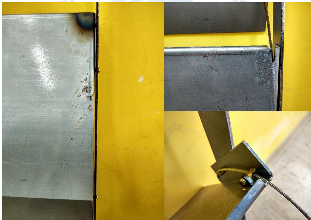
圖 3-11 置物架第一版原型：餘裕小、溝槽小、間距小鋼纜無法鎖固
